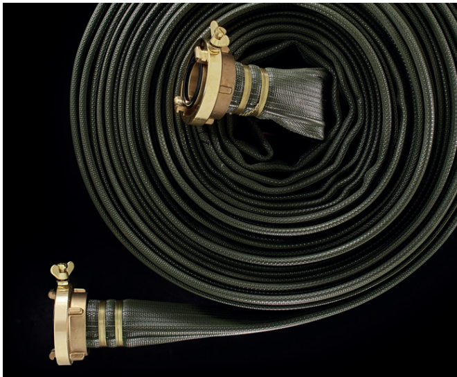
Abgebildeter Schlauch: GH Hilcoflex Oil Alle Hilcoflex Oil Schläuche mit Messing-Kupplung müssen mit Messing Draht eingebunden werden
